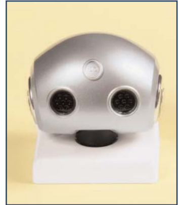
Com o sexto fascículo receberá um pedestal provisório (a base branca) que lhe permitirá testar alguns elementos da cabeça de O SEU ROBOT antes de acabar de montar o resto do corpo, como o motor, os LED dos olhos e das orelhas e o sensor de contacto.
